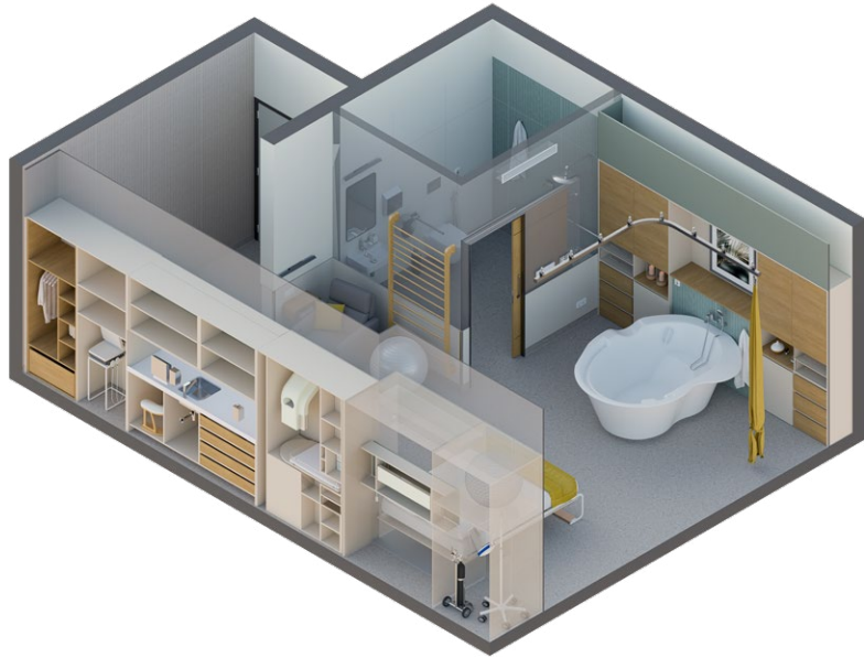
Figura 4. Diseño final de la sala de nacimiento, en la que se observa la zona húmeda, con la bañera obstétrica y los elementos auxiliares requeridos para dar apoyo a la madre durante el parto (elaboración propia)
