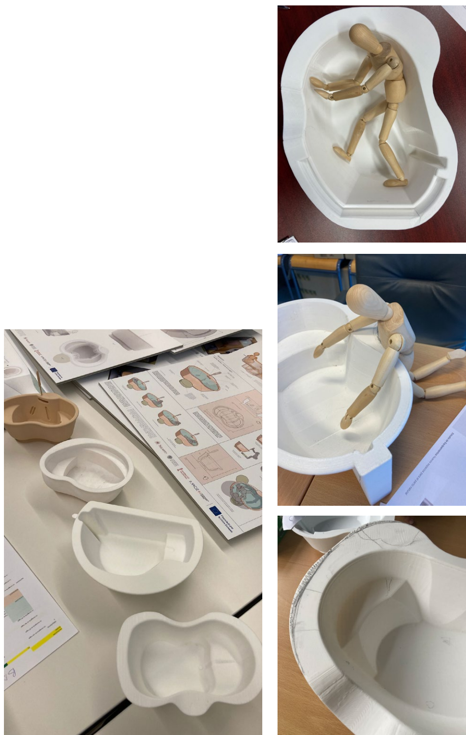
Figura 2. Propuestas iniciales, evolución del diseño, comprobaciones y ajustes del desarrollo de la bañera “New Life”. Fuente: Asistencias técnicas y elaboración propia
